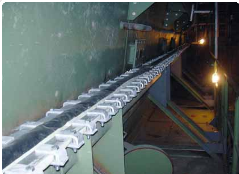
Compensateur liaison Four/Trémie - Montage par étriers - Temp. 400°C Liaison Compensator Oven/Hopper-Stirrup Mounted- Temp. 400c
